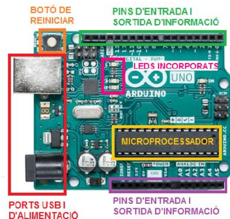
Fig. 9. Arduino UNO amb les seves parts més importants 38 .
