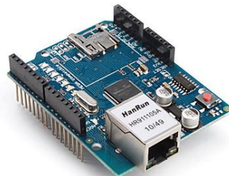
Fig. 17. Ethernet shield . És utilitzada per connectar l'Arduino a Internet 55 .
