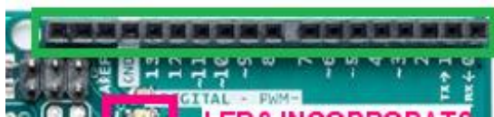
Fig. 11. Pins d'entrada i sortida digitals 46 .
