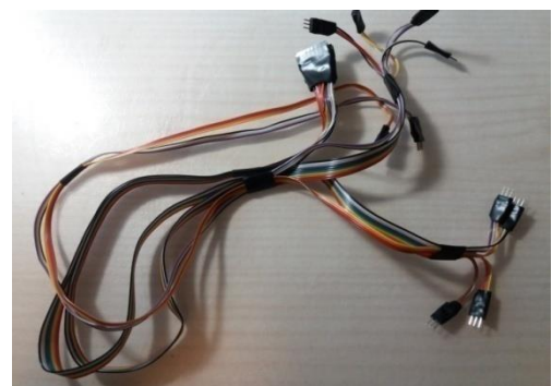
Fig. 25. Acabat final dels cables. A baix a la dreta s'hi poden apreciar quatre clavilles amb els seus tres pins respectius 81 .
