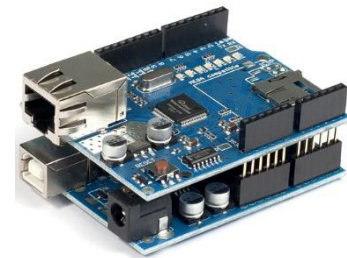
Fig. 18. Arduino UNO juntament amb la placa Ethernet 56 .
