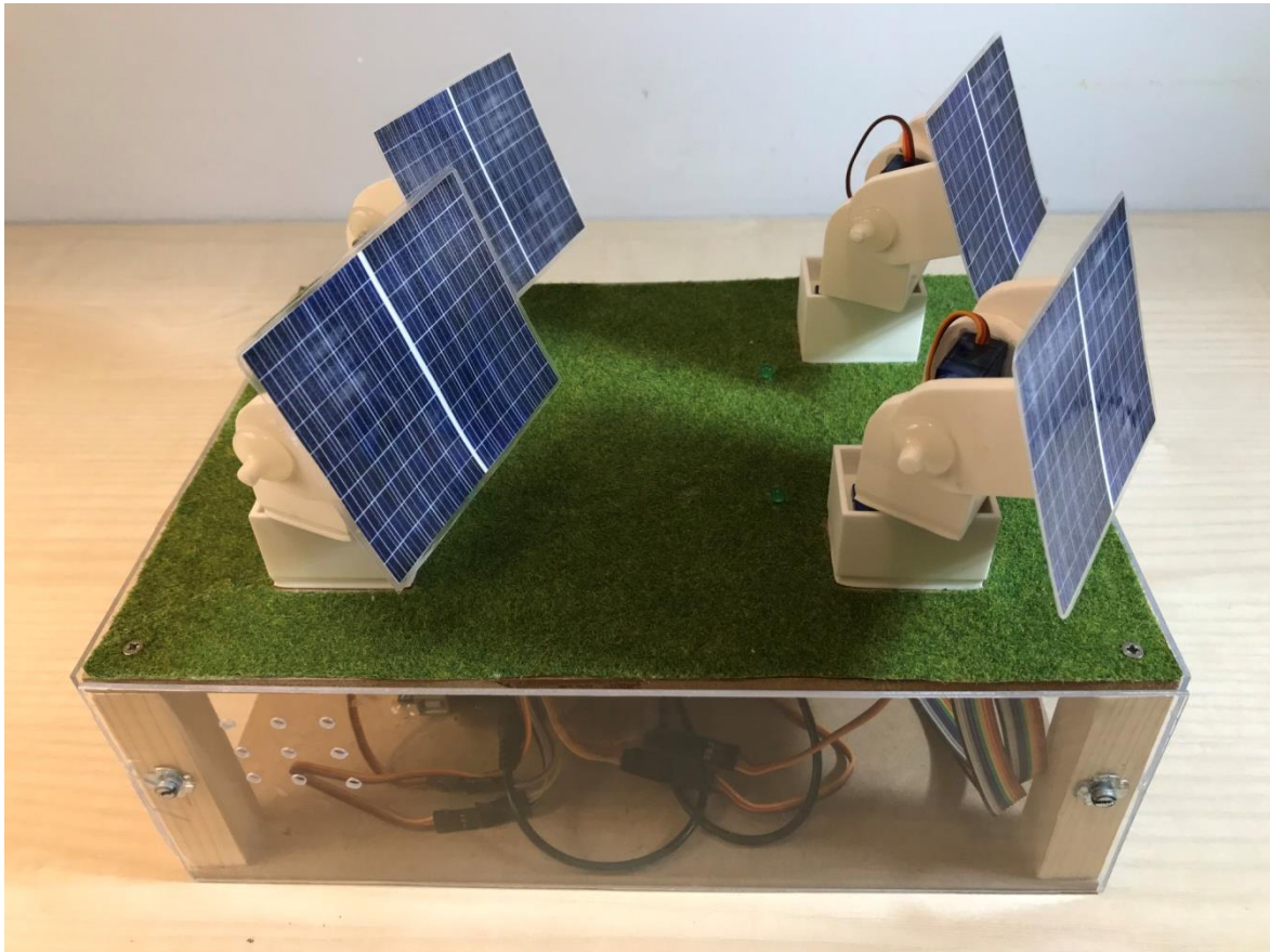
Fig. 31. Imatge final que mostra el model a escala de la central fotovoltaica finalitzat. A dalt a l'esquerra de la franja de plàstic de davant s'hi poden apreciar 9 dels 18 forats fets per la ventilació de l'electrònica 87 .
