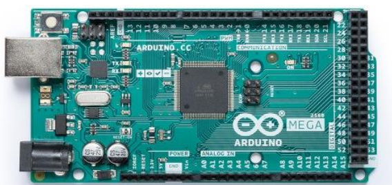
Fig. 14. Arduino MEGA. Disposa de més pins digitals i analògics i més memòria Flash i EEPROM 52 .
