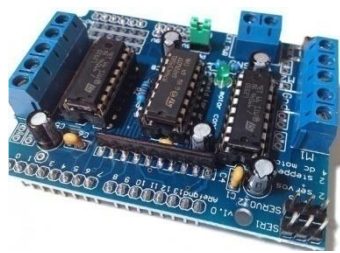
Fig. 16. Arduino shield pel control de motors. Generalment s'utilitza en cotxes teledirigits 54 .
