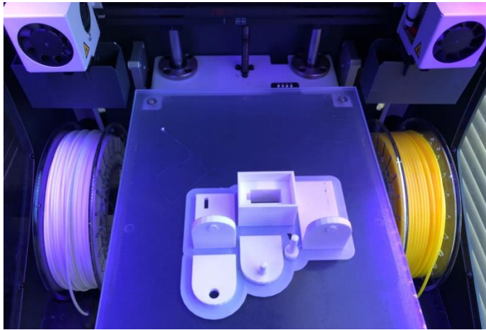
Fig. 26. Finalització de la impressió de les peces en tres dimensions. Aquesta impressora 3D disposa de dos extrusors. Només un va ser utilitzat per la impressió 82 .
