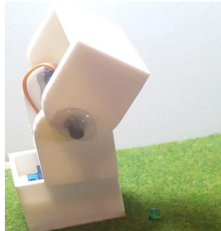
Fig. 27. Seguidor solar construït i col·locat a la plataforma superior 83 .
