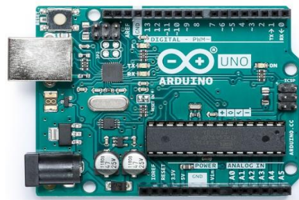
Fig. 13. Arduino UNO. Els cables que s'hi connecten es poden connectar directament al pins de color negre sense necessitat d'una placa de proves 51 .
